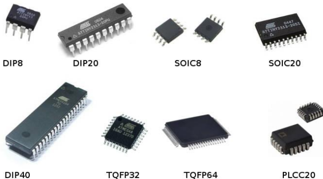
Рис. 1.3 – Корпуси мікроконтролерів AVR–DIP, SOIC, TQFP, PLCC
