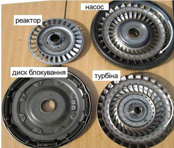
Гідротрансформатор (ГдТ) виконує гідравлічне щеплення між двигуном і АТ і складається з корпусу з відцентровим насосним колесом, реактора (або статора, направляючого колеса) на обгінній муфті, доцентрового турбінного колеса, механізму блокування.
